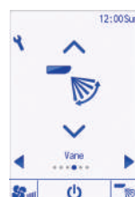
Controlo dos defletores
